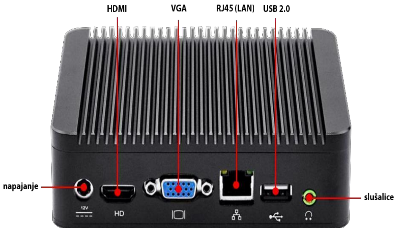
Slika 2. SG-1 zadnji panel – lokacija i tip konektora
