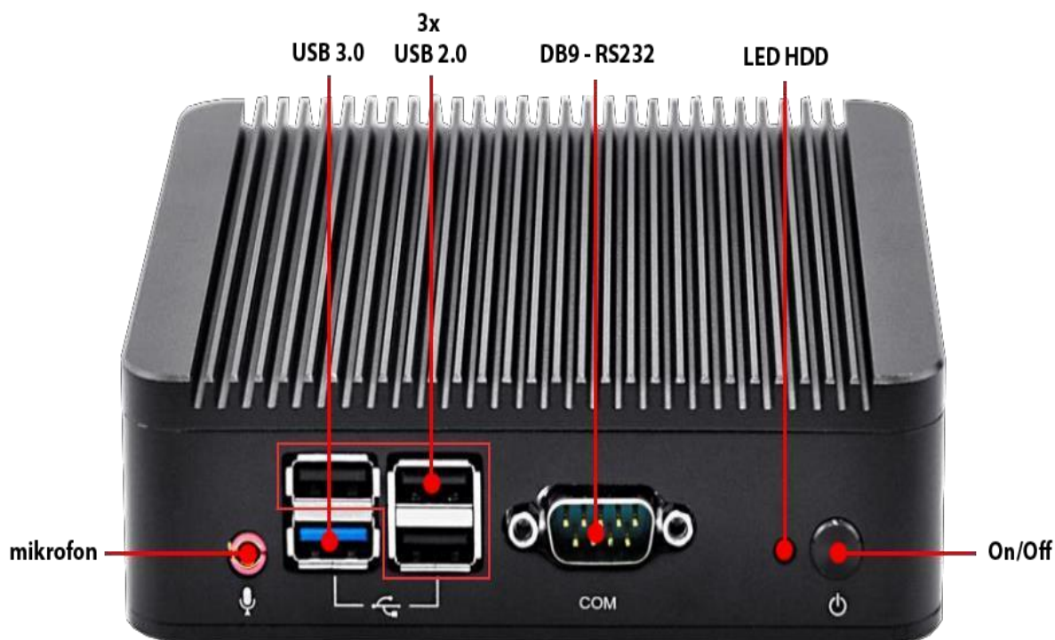
Slika 1. SG-1 prednji panel – lokacija i tip konektora
