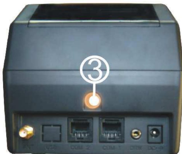
Slika 17. Mesto za servisnu plombu
