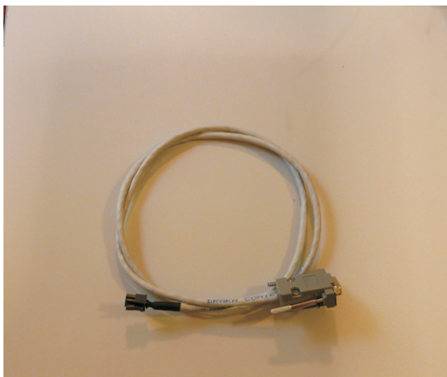
Slika 2. - Kabli za serijsku komunikaciju sa računarom za priključenje na terminal ima na jednoj strani 6 pinski Molex microfit
