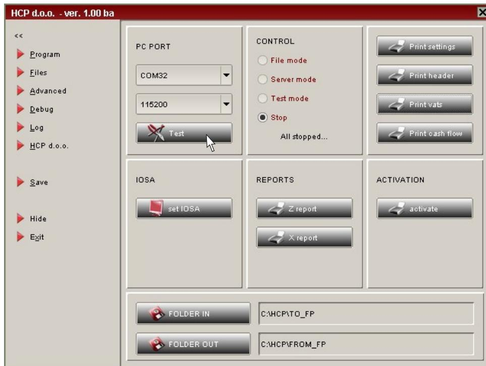
Slika: Test veze serijskog porta između PC -a i fiskalnog uređaja
