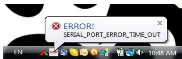
Slika: Poruka da PC nema komunikaciju sa uređajem
