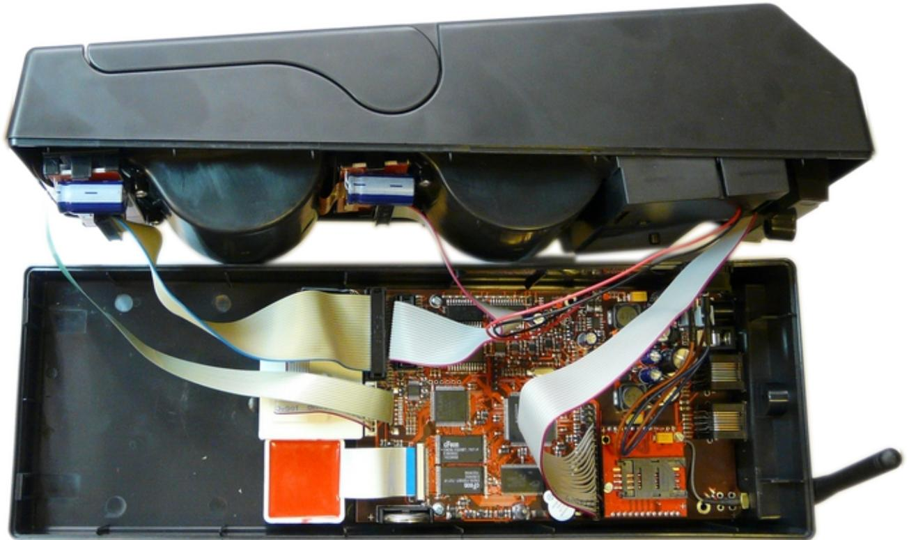
Slika 42. - Povezati gornju i donju ploču kablovima. Obratiti pažnju na polarizaciju, crvena na kablu za displej treba da bude okrenuta na stranu GSM antene. Elektronski žurnal u konektor sa leve strane fiskalne memorije. Postaviti flet kabal tastature i dodati papirne rolne.
