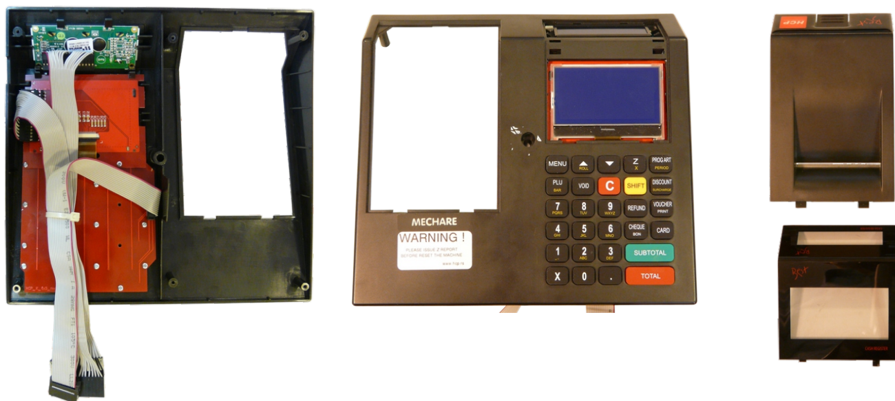
Slika 31. - Kablove za tastaturu i displeje povezati vezicom. Na kućište još idu i poklopac za displej i štampač. Nalepnice se postavljaju ispod poklopca štampača kao na slici.
