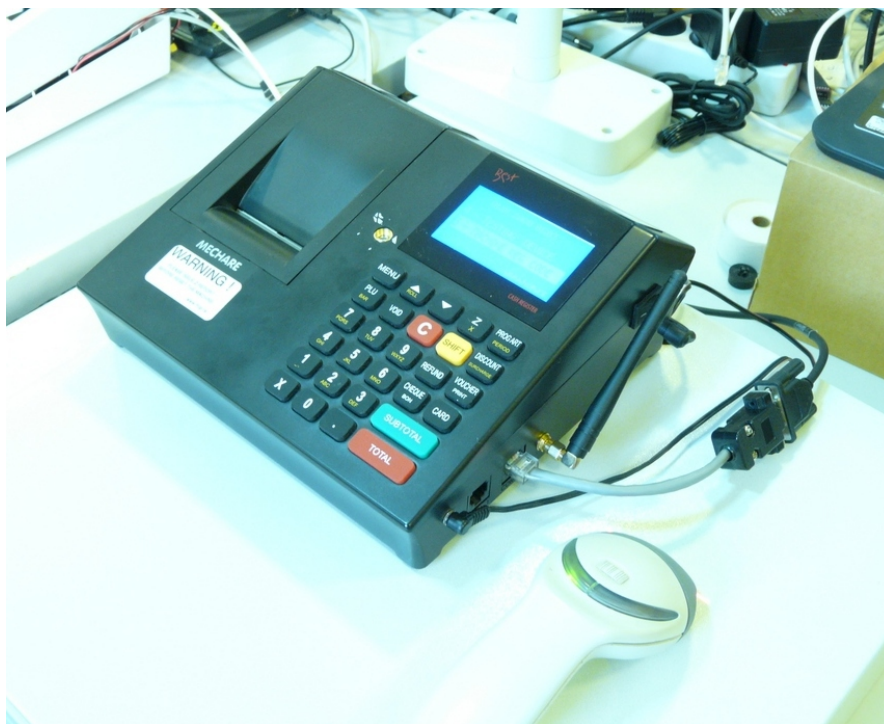
Slika 39 - Kompletно sklopljen uređaj sa priključenim periferijskim dodacima, Fiokom za novac i Bar kod skenerom, spreman za testiranje i stavljen na externo napajanje
