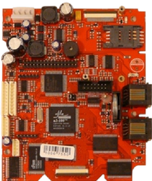
Slika 4. PCB – Matična ploča sa SMT i Trough hole komponentama spremna za montažu.
