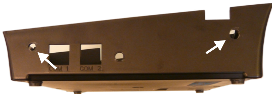
Slika 21. - Bušenje otvora za fioku 6mm i DC konektor 8mm
