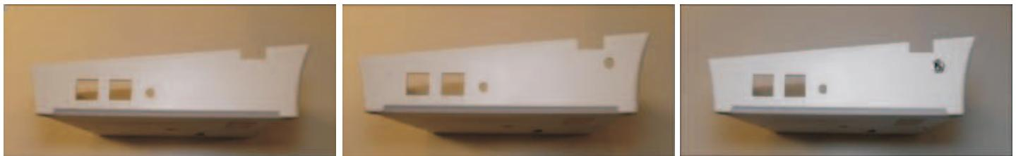
Slika 14. - Bušenje otvora za **DC konektor 8mm**
