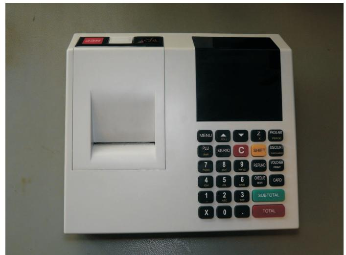
Slika 27 i 28. - Sa donje strane šest zavrtnja se šrafe za spajanje gornjeg i donjeg kućišta. Centralni vijak ide sa nosačem plombe. Na postolju na kraju nalepiti gumene nožice za bolju stabilizaciju postolja uređaja. Na slikama se vidi izgled kompletno sklopljenog uređaja
