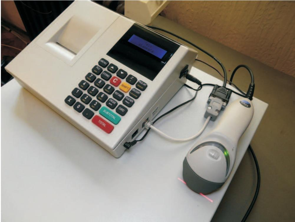
Slika 33. - Kompletno sklopljen uređaj sa priključenim periferijskim dodacima, Fiokom za novac i Bar kod skenerom, spremjan za testiranje i stavljen na externo napajanje
