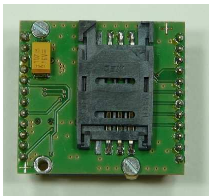
Slika 7. - Izgled modema sa gornje strane, na kome se vidi mesto za SIM karticu (Pull-up holder),
