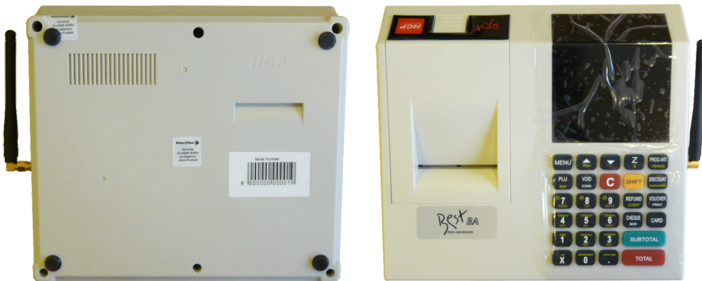
Slika 38 i 39. - Sa donje strane šest zavrtnja se šrafe za spajanje gornjeg i donjeg kućišta. Centralni vijak ide sa nosačem plombe. Na postolju na kraju nalepiti gumene nožice za bolju stabilizaciju postolja uređaja. Na slikama se vidi izgled kompletno sklopljenog uređaja
