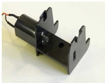
Slike 23,24,25. - Na nosač postaviti elektromotor i ušrafiti, postaviti gumicu na elektromotor, postaviti kotur sa tegom.
