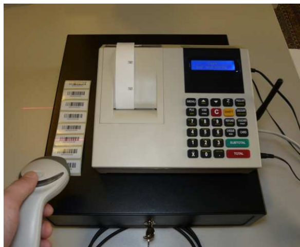
Slika 47 i 48. - Testiranje bar kod porta i fioke za novac
