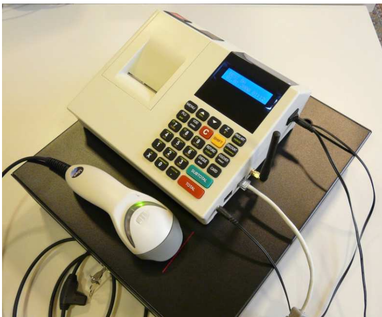
Slika 44. - Kompletно sklopljen uređaj sa priključenim periferijskim dodacima, Fiokom za novac i Bar kod skenerom, spreman za testiranje i stavljen na externo napajanje
