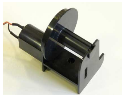
Slike 23,24,25. - Na nosač postaviti elektromotor i ušrafiti, postaviti gumicu na elektromotor, postaviti kotur sa tegom.
