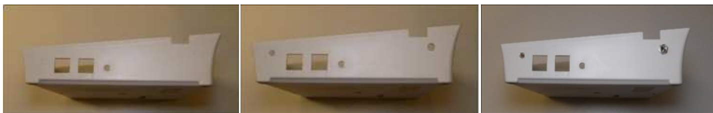
Slika 16. - Bušenje otvora za fioku 6mm i DC konektor 8mm
